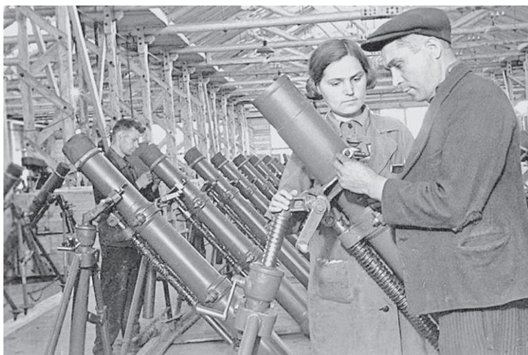
Заводская приёмка готовых 120-мм упрощённых полковых миномётов образца 1941 года (ПМ-41) в миномётном цехе на заводе № 4 имени Ворошилова. Красноярск, скорее всего лето 1942 г.
